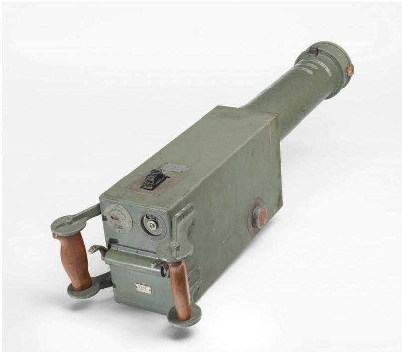
Die „Maschinengewehrkamera“ wurde im Ersten Weltkrieg von Oskar Messter (1866-1943) entwickelt und von der Firma Ernemann in Dresden gebaut. Vorbild war das reale Maschinengewehr MG 08. Die Handgriffe des Abzugs waren identisch, ebenso die Visiereinrichtung. Statt eines Patronengürtels enthielt die Kamera einen Filmstreifen.
