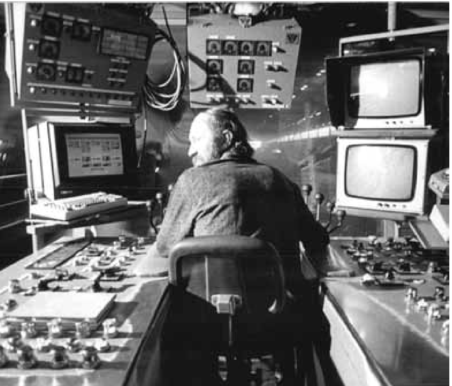
Modernes Walzwerk der Maxhütte Unterwellenborn bei einer Generalreparatur 1989: Walzensteller Hans-Peter K. bedient hier die Steuerbühne, während ihm Monitore einzelne Walzprozesse anzeigen. Ein Computer dient dabei der vollautomatischen Prozessüberwachung.
