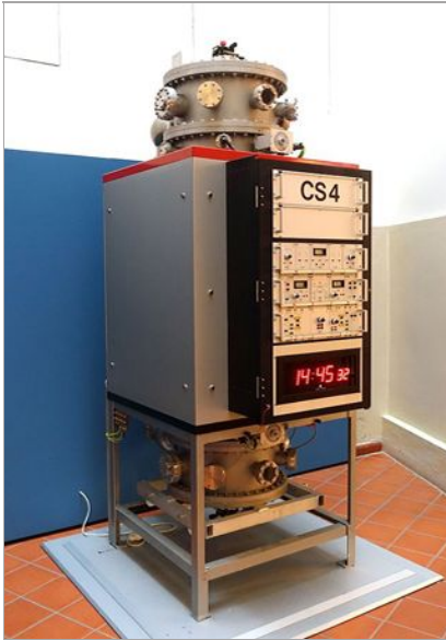
Atomuhr CS4, Physikalisch-Technische Bundesanstalt, Braunschweig 1992. Braunschweigisches Landesmuseum, Braunschweig, Deutschland. Fotograf: Daderot, 18. November 2014. Quelle: Wikimedia Commons (CCO 1.0 Universal)
