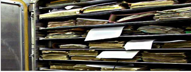
Vakuum- Gefriertrocknungskammer geöffnet, Zentrum für Bucherhaltung GmbH, 2006, Foto: Manfred Anders
